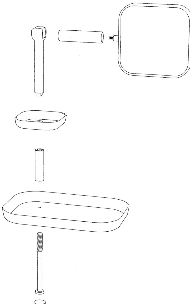
Вертикальная часть органайзера скрепляется одним болтом с головкой под крестовую резьбу. После сборки вертикальной части закройте головку болта прокладкой, которая идет с ним в комплекте. Для сборки органайзера VANA вам потребуется крестовая отвертка. Отвертка не входит в комплект поставки.
